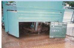
中型切断機：シャッターにより飛散、騒音なし
